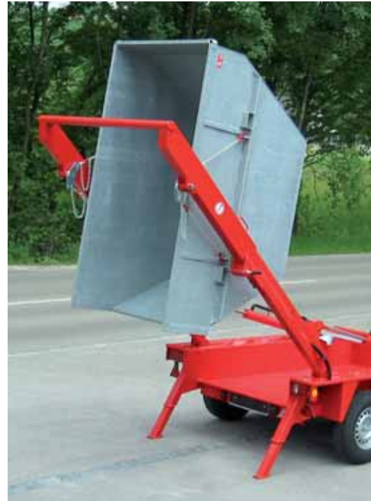
Container können mit teleskopierten Hubarme hoch ausgeleert oder in andere Container umgeleert werden.
