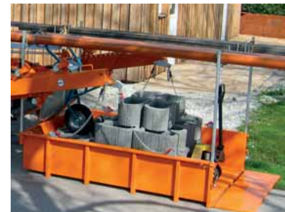
Das H-Gestell auf dem Flachcontainer ermöglicht den Transport längerer Güter, wie Stangen, Rohre, usw.
