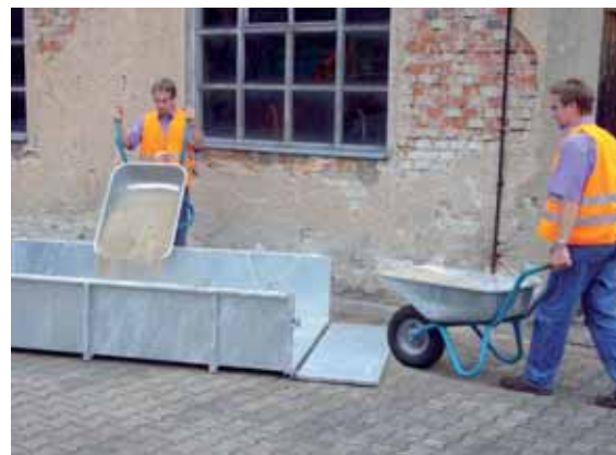
Schüttgut kann leicht beladen werden und verrutscht beim waagrechten Aufnehmen des Containers nicht.
