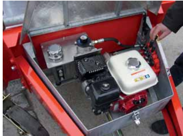
Unabhängiger Antrieb der Hydraulikanlage durch einen Honda Benzinmotor mit angeflanschter Pumpe.
