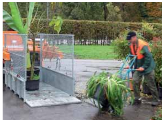
Der Flachcontainer kann ebenerdig beladen und in der waagrechten aufgenommen werden.
