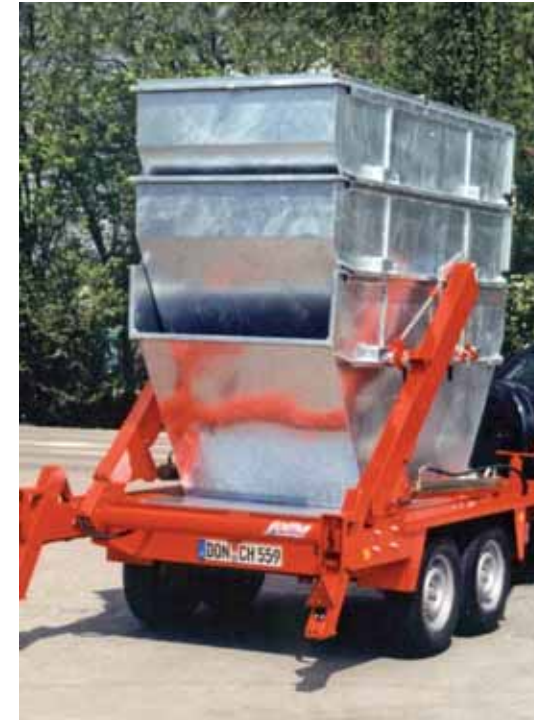
Die Container können gestapelt und dadurch mehrere Baustellen mit einer Fahrt entsorgt werden.
