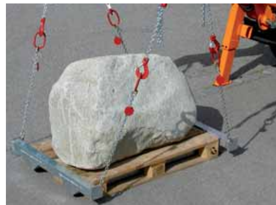
Mit dem Palettenhubgestell können Güter auf Euro-Paletten schnell be- und entladen werden.
