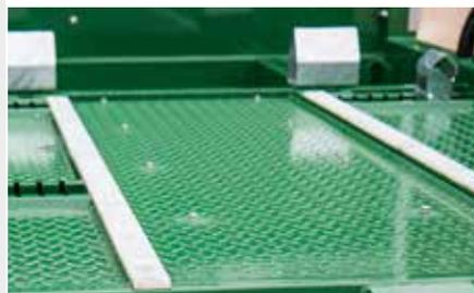
Abriebschutz auf den Längsprofilen des Anhänger-
