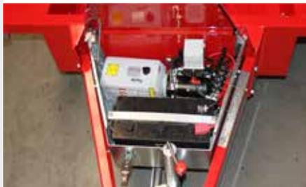
SPX-Elektroaggregat mit Versorgung durch eine 180 Ah Batterie. Eingebaut in eine Staukiste an der Bugwand des Anhängerrahmens. (Aufpreis zum benzinhydraulischen Antrieb.)
