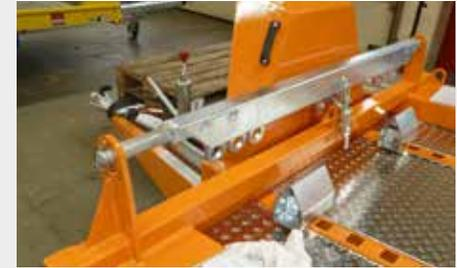
Querstange zum Aufsetzen auf die Hubarme des ACON zum Aufnehmen von Punktlasten. Inklusive Halterung am Bug. Nicht nachrüstbar, an den Hubarmen muss eine Aufnahme angeschweißt werden.
