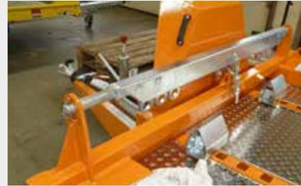
Querstange zum Aufsetzen auf die Hubarme des ACON zum Aufnehmen von Punktlasten. Inklusive Halterung am Bug. Nicht nachrüstbar, an den Hubarmen muss eine Aufnahme angeschweißt werden.
