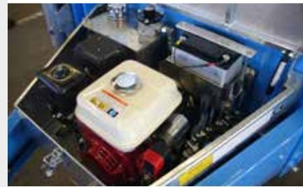
Elektro-Starter für den Benzinmotor. Inklusive Starterbatterie.
