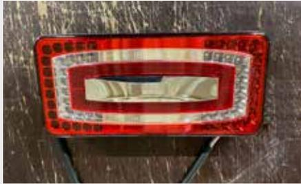
Lichtanlage komplett mit LED anstelle von Glühlampen. Für Zugfahrzeug mit LED-Lichtanlagenerkennung oder Einbau einer LED-Kontrollbox (Bestell-Nr.: 50227)
