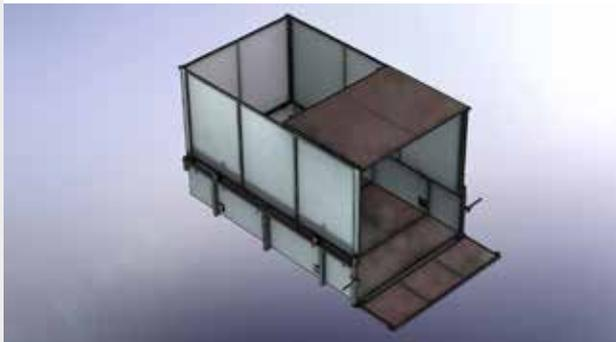
Vierteiliger Stahlblechaufsatz mit Pendelklappe. Auf den Flachbehälter FL 1524 aufgesteckt und mit Schrauben gesichert.
