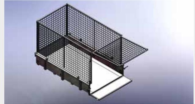
Vierteiliges Laubgitter mit Pendelklappe. Auf den Flachbehälter FL 1524 aufgesteckt und mit Schrauben gesichert.
