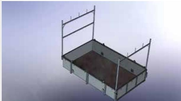
Zweiteiliges Gestell zum Transport von leichten Gütern, deren Länge die Flachbehälterlänge übersteigt. Auf den Flachbehälter FL 1524 aufsteckbar und mit Schrauben gesichert.
